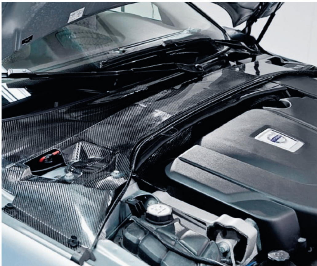
LEGERISSIME Due esempi di batterie strutturali. Sono fatte con pannelli sottili di tessuti di carbonio. Ogni anno vengono presentati nuovi brevetti che riguardano il processo per realizzarle
